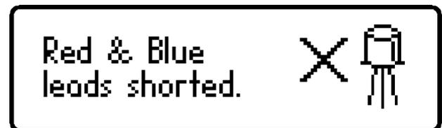
Wenn alle drei Messfühler kurzgeschlossen sind (oder einen sehr geringen Widerstand aufweisen), wird folgende Meldung angezeigt:
