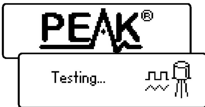
Bei der ersten Analyse (nachdem das Gerät ausgeschaltet wurde) werden die Tests durchgeführt, während das Peak-Logo angezeigt wird.
