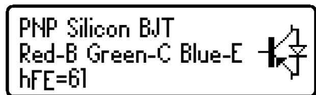
Il Philips BU505DF è un tipico esempio di transistor bipolare protetto da diodo. Va ricordato che il diodo (se presente) è sempre collegato internamente tra il collettore e l'emettitore in modo da avere normalmente polarizzazione inversa.
