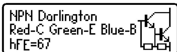
Tuttavia, questo secondo esempio (a sinistra) mostra la schermata per un transistor Darlington che ha resistenze interne collegate alle connessioni base-emettitore. Ciò causa che le misurazioni di  $h_{FE}$  diventino molto basse alle correnti di prova utilizzate da *DCA Pro*. Questo è normale e non indica un difetto del transistor o di *DCA Pro*.
