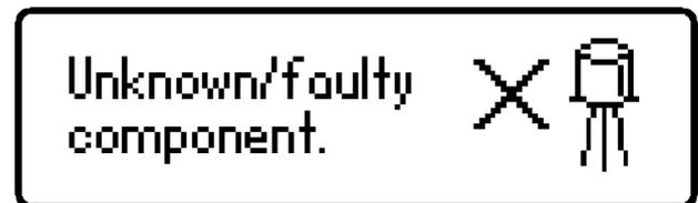
Alcuni componenti possono essere difettosi a causa di un collegamento in cortocircuito tra una coppia di sonde. In questo caso, viene visualizzato il seguente messaggio (o simile):
