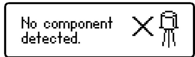
Se il componente non è di tipo supportato, è difettoso o è inserito in un circuito, l'analisi può dare il seguente messaggio:
