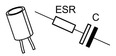
effektiv mit einem idealen Kondensator in Reihe geschaltet ist.
