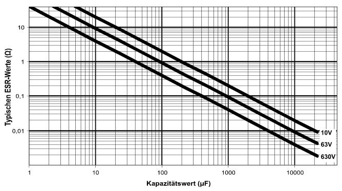
Bitte beachten Sie, dass es sich bei den obengenannten Werten nur um **typische** Werte für elektrolytische Geräte mit Standardqualität bei Zimmertemperatur handelt. Bitte vergleichen Sie die abgelesenen Werte mit den Werten für den zu prüfenden Kondensatortyp.
