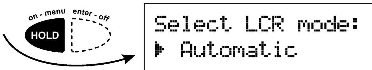
Der derzeit aktive Modus wird mit dem Symbol **▶** angezeigt. Sie können alle verfügbaren Modi durchgehen, indem Sie kurz **An-Menü** drücken. Dies ist auf der nächsten Seite zu sehen.
